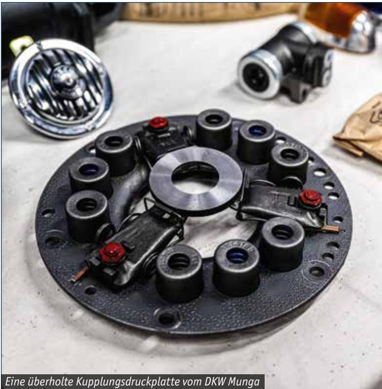
Eine überholte Kupplungsdruckplatte vom DKW Munga
